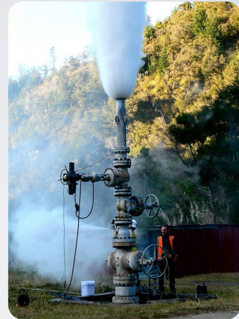
13 MW Geothermal Bore Test (Kawerau, New Zealand)
